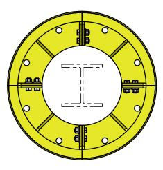
**STEP 1:** POSITION THE COLUMN GUARDS AROUND COLUMN
